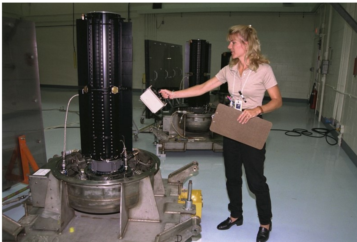
(Aparat de măsurare a camerei ionice de mână utilizat pentru măsurarea ratei dozei de suprafață pe una dintre cele trei generatoare termoelectrice radioizotopice pentru nava spațială Cassini.)
