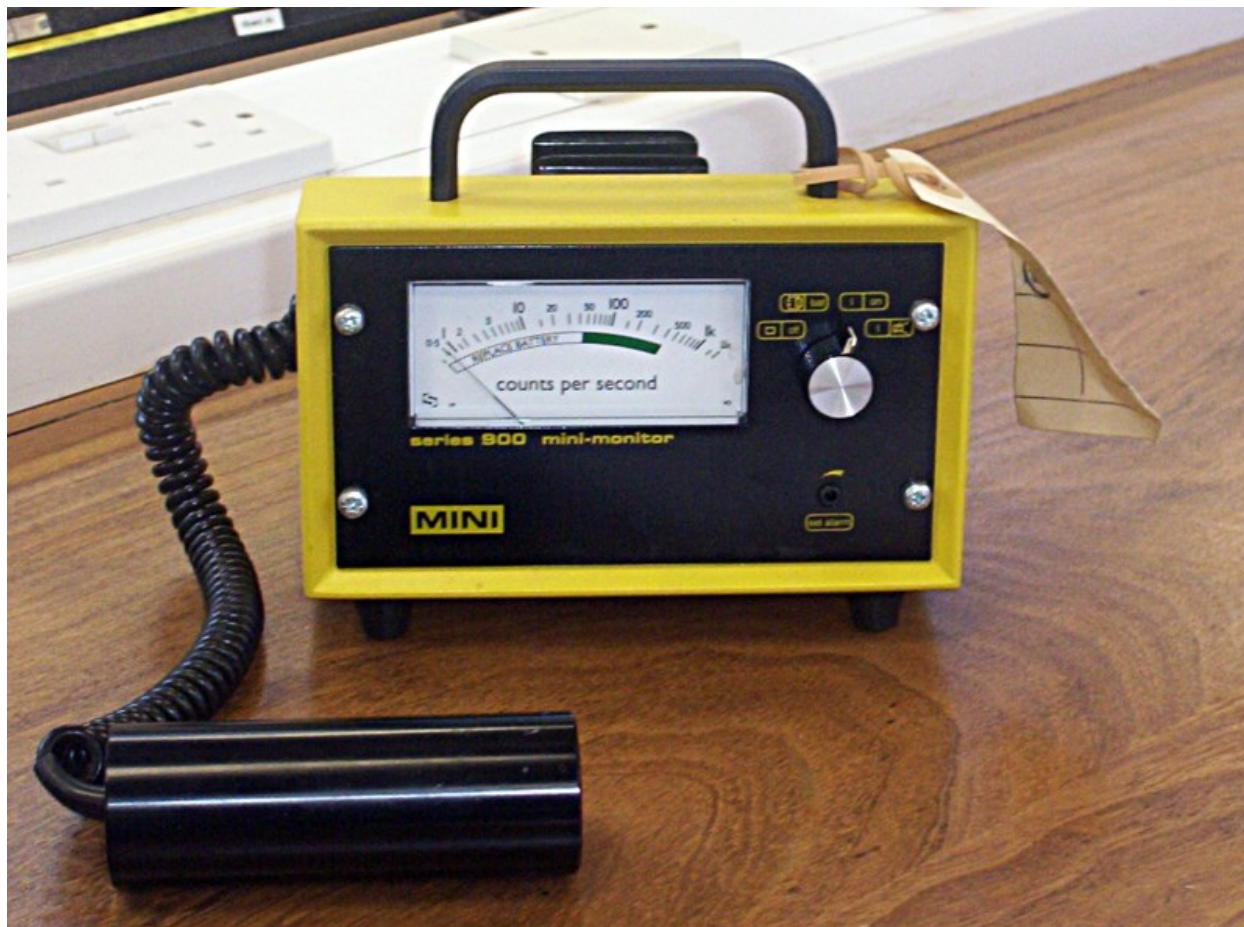
(Un contor complet Geiger, cu tubul Geiger-Muller montat într-o incintă cilindrică conectată printr-un cablu la instrument. Sursa: Boffy b, https://en.wikipedia.org/wiki/File:Geiger_counter.jpg .CC Attribution-Share Alike 3.0 Unported license)
